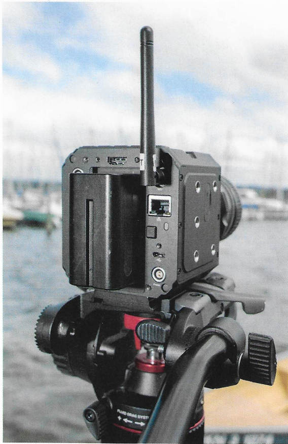
Die Kameras sind gerüstet für die direkte Kommunikation und haben sowohl WLAN als auch Ethernet-Anschluss.
