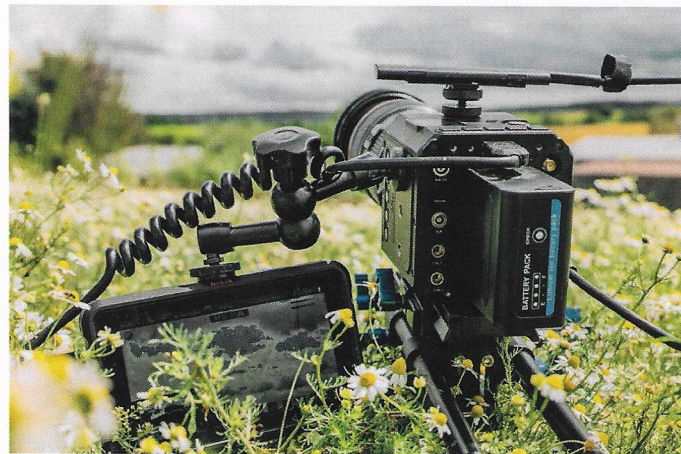
Die Z Cam E2-Serie hat nur einen CFast-Speicherkarten-Slot. Wer mehr preisgünstigen Speicher benötigt, schließt direkt ein SSD-Laufwerk per USB-C an die Kamera an.
